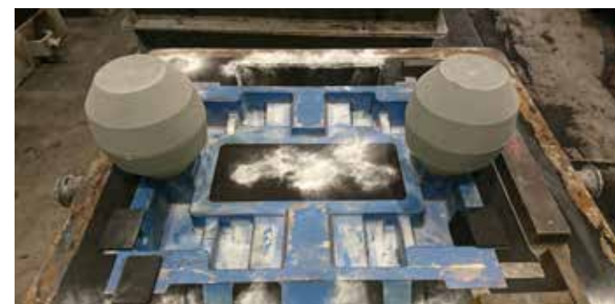
THERMO-Speiser® mit NETCore® Brechkern vor dem Formen
