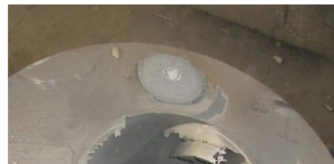
NETCore® Gussstück vor Putzvorgang (Speiserrest abgeschlagen)
