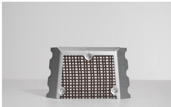
Speziell entwickelt für das einfache Entfernen von großen Seitenspeisern. Das NETFrame® wird in den Übergang von Speiserhalskalotte zum Bauteil – direkt an der Bauteiloberfläche – positioniert und bildet somit eine definierte Sollbruchstelle des Seitenspeisers aus.
