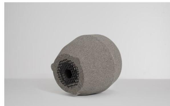
Entwickelt worden für Anwendung von Kopfspeisern in Handformereien. Hierbei kann auf eine leistungs-reduzierende Einschnürung durch einen Brechkern verzichtet werden, wobei das Entfernen des Speiserrestes aufgrund des flächenbündig angebrachten Gewebes einfacher möglich ist.
