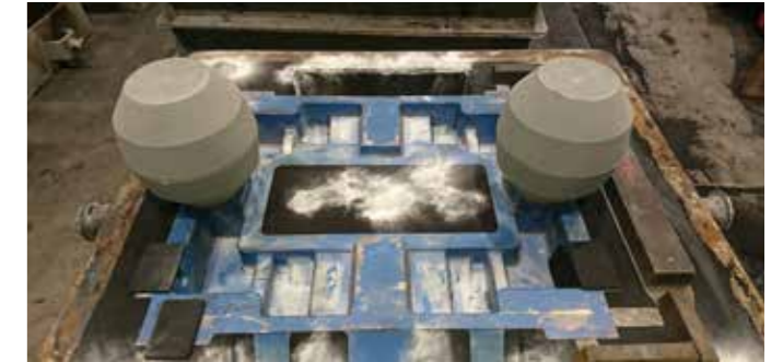
NETCore® Brechkern nach dem Einformen
