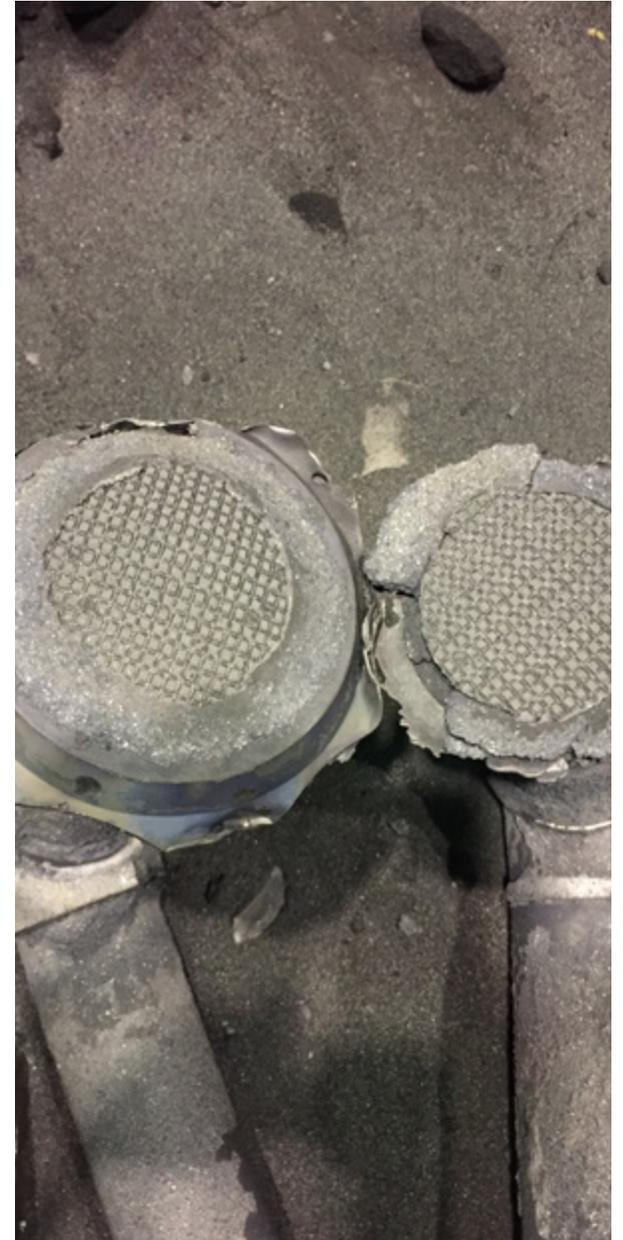
*Stresstest anhand Eingusssysteme mit eingebauten Netzen (Durchmesser 100mm)*
